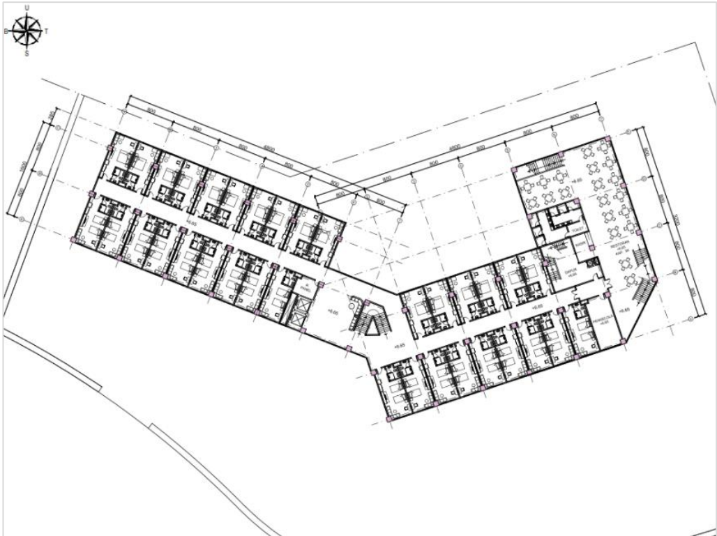
Gambar 5.4 Denah Gedung Utama Lantai 2 Sumber : Pribadi, 2022
