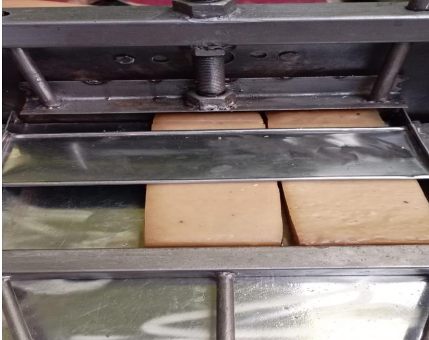
Proses pemotongan kerupuk
