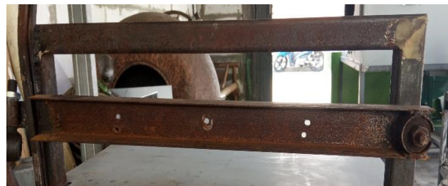
Gambar 4. 5 Pembuatan dudukan pisau
