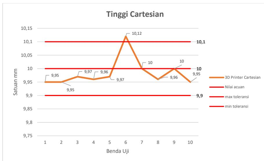
Gambar 4. 12 Grafik batas toleransi tinggi balok 3D *printer* cartesian
