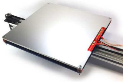
Gambar 2. 5 *Build platform* atau *bed* 3D printer
