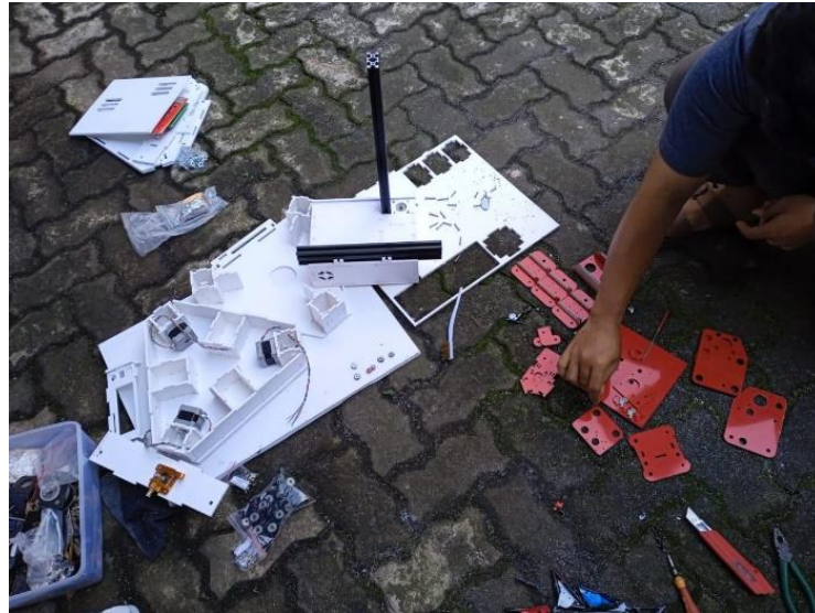
Gambar 3. 7 Proses pemotongan dan perakitan alas
