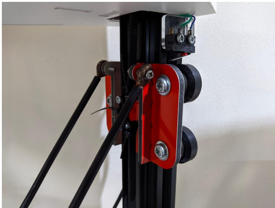
Gambar 3. 12 Proses perakitan lengan ayun, pada frame dan limit switch
