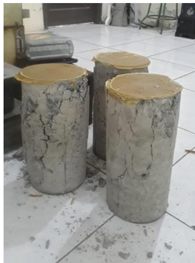
Gambar 4. 17 Sampel Beton setelah Pengujian Kuat Tekan
