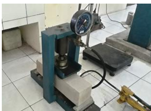
Gambar 4. 18 Pengujian Kuat Lentur Beton
