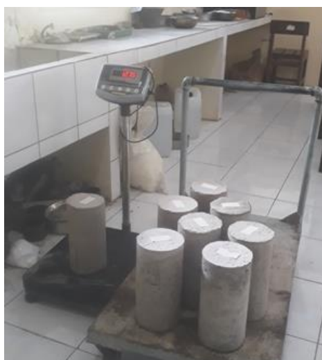
Gambar 4. 14 Pengujian Berat Isi Beton Kering
