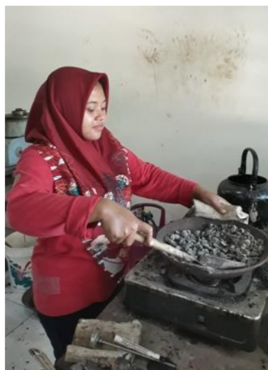
Gambar 4. 4 Penggorengan Agregat Kasar Sebelum Pengujian Gradasi
