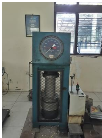
Gambar 4. 16 Pengujian Kuat Tekan Beton Campuran 20% Fly Ash + 2,5% Lumpur
