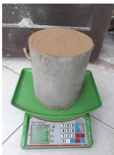
Gambar 4. 8 Pengujian Berat Isi Fly Ash
