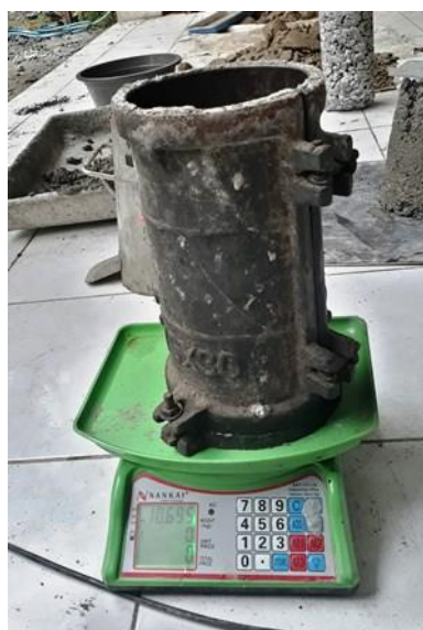
Gambar 4. 13 Penimbangan Cetakan sebelum Pengujian Berat Isi Beton Segar
