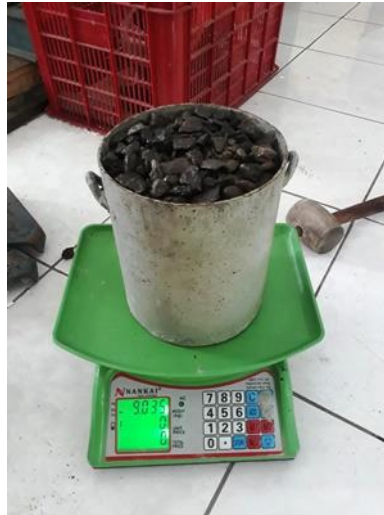
Gambar 4. 6 Pengujian Berat Isi Agregat Kasar
