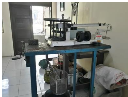
Gambar 4. 5 Penimbangan Agregat Kasar dalam Pengujian Berat Jenis dan Penyerapan
