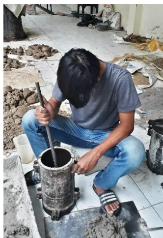
Gambar 3. 9 Proses Memasukkan Beton Segar kedalam Cetakan
