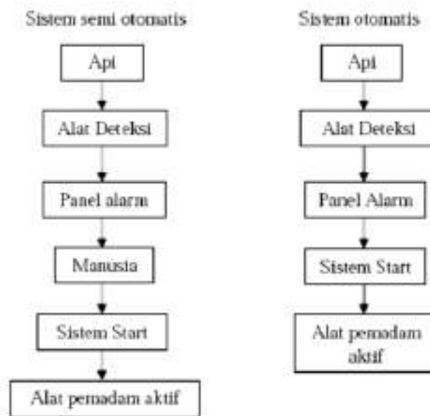
Gambar 4.12 Skema Sistem Pemadam Kebakaran (Sumber: Data Pribadi, 2024)
