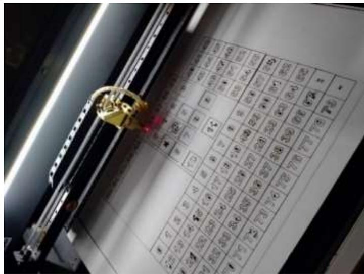
**Gambar 4. 2 Proses Pembuatan dengan Mesin Pemotong Laser**
