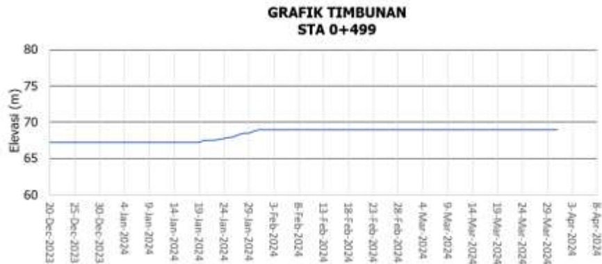
Gambar 4. 17 Grafik Kenaikan Elevasi Timbunan (Sumber : Data Proyek Bendungan Jragung, 2024)
