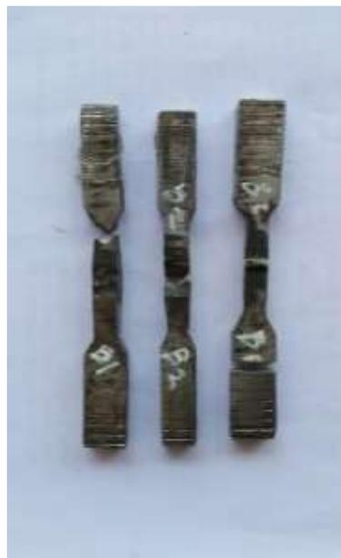
Gambar 4. 4 Hasil Spesimen Uji Tarik Arus 100 Ampere
