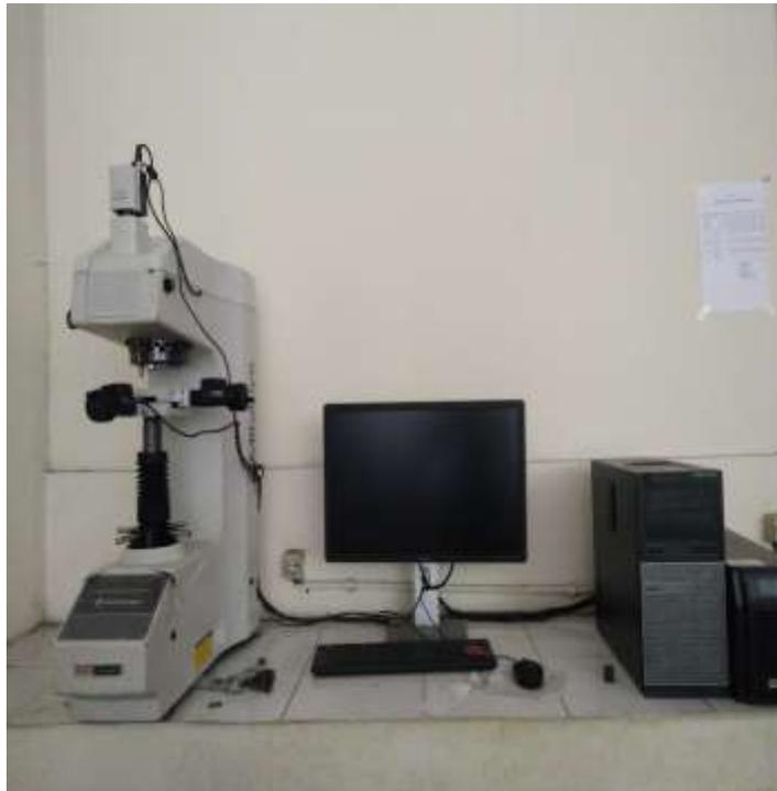
Gambar 3. 2 Alat Uji Kekerasan
