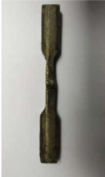
Gambar 3. 7 Spesimen Uji Tarik
