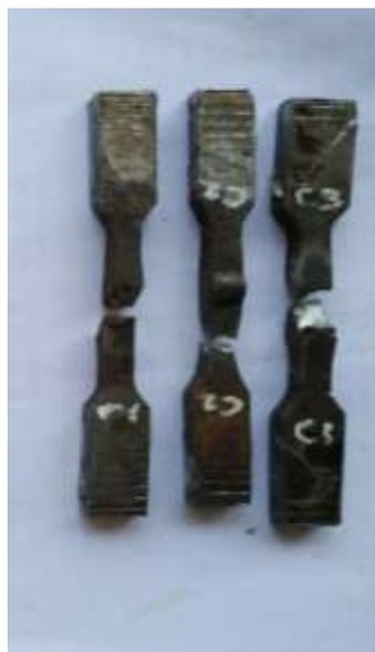
Gambar 4. 6 Hasil Spesimen Uji Tarik Arus 110 Ampere
