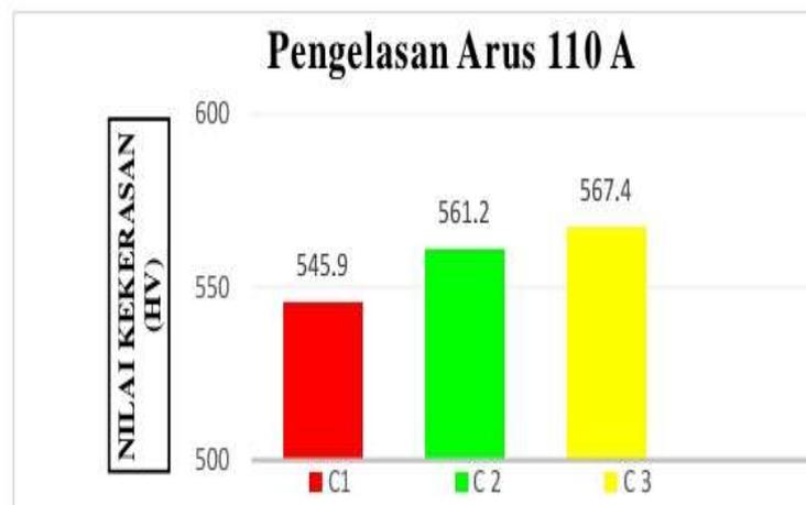
Gambar 4. 16 Grafik Nilai Kekerasan Arus 110 Ampere
