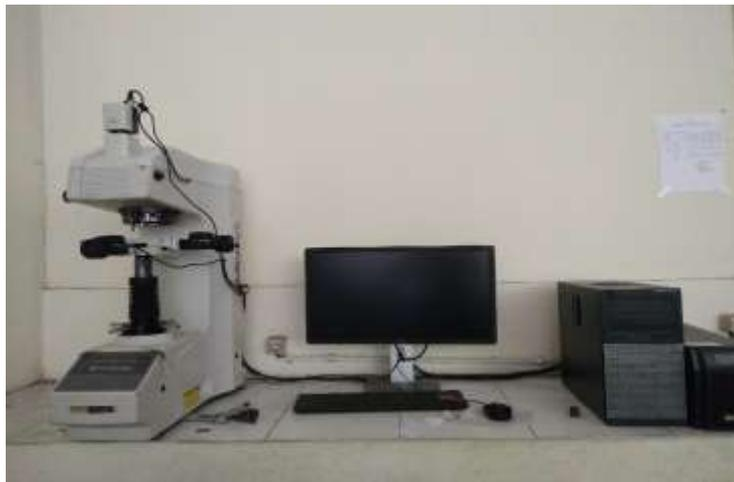
Gambar 3. 9 Pengujian Kekerasan Vickers
