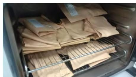
*Azolla pinnata* dimasukkan ke dalam oven dengan suhu 90°C selama 2 x 24 jam
